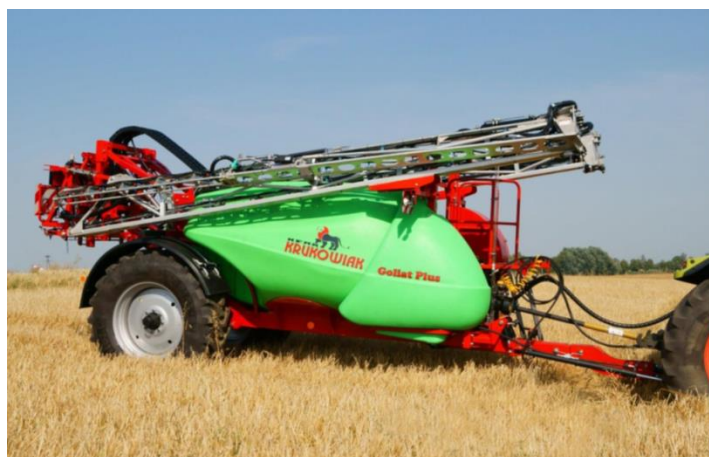
Przyczepiany opryskiwacz rolniczy Goliat Plus P387o poj. zbiornika 2500 l. Producent: Kujawska Fabryka Maszyn Rolniczych „KRUKOWIAK” Sp. z o.o. z Brzeźcia Kujawskiego
